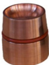
Медный под с углублением диаметром 40 мм для плавки
