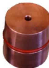
Медный под с углублением диаметром 5 мм для плавки
