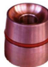
Медный под с углублением диаметром 18 мм для плавки
