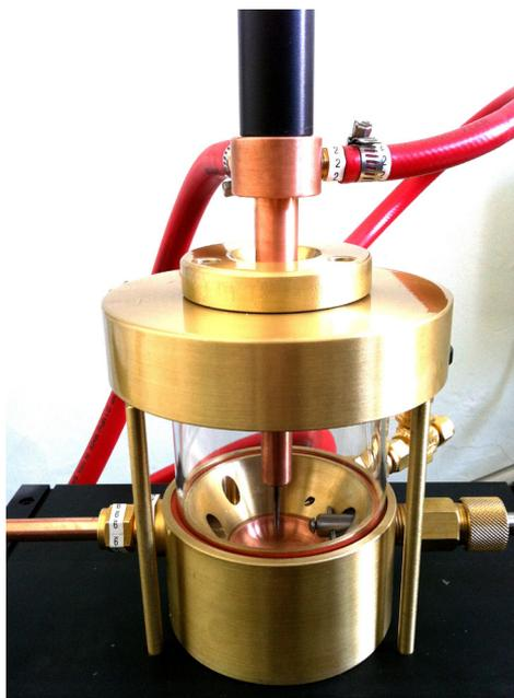
из нее воздуха и заполнения инертным газом. После того, как камера печи очищена, а требуемая мощность тока выставлена на источнике питания, остается зажечь дугу и расплавить образец. В случае необходимости можно перевернуть образец. В камере печи имеются специальные отверстия для размещения небольшого количества титана. Для удаления примесей из камеры печи можно расплавить небольшой образец титана.
