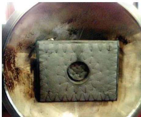
Рис.2. Камера печи после вакуумной депарафинизации.
