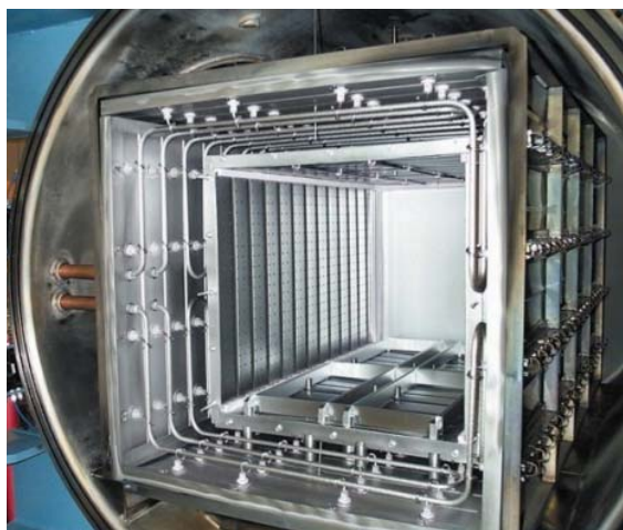
Рис.8. Реторта печи MIM-Vac™, изготовленная из молибдена.
