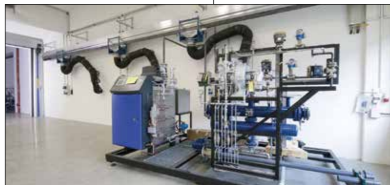
Система удаления выхлопных газов для двигателей внутреннего сгорания и паровых машин
