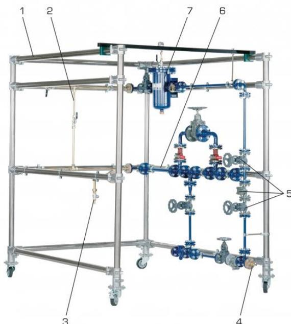
1 Труба DN15, 2 передвижная рама, 3,4 подключение к насосной станции, 5 различные клапана и фитинги, 6 труба DN 25, 7 напорный бак с манометром
