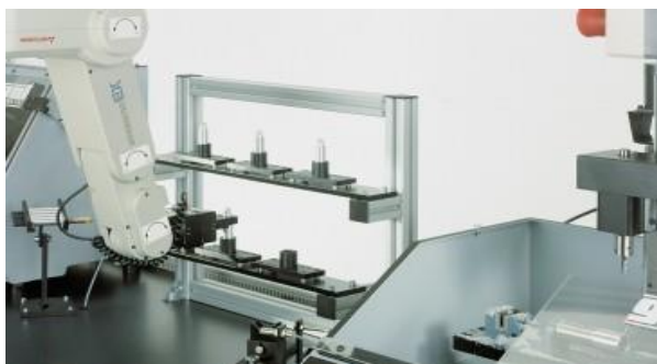
Помещение готовой детали на склад хранения
