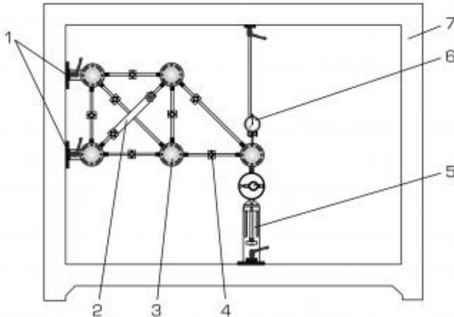
1 опоры, 2 дополнительная балка (регулируемая), 3 узловой диск, 4 балка с точкой измерения сил, 5 устройство приложения нагрузки, 6 индикатор часового типа с зажимным приспособлением, 7 рама SE 112
