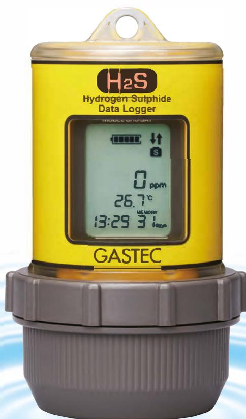
**Встроенный регистратор данных позволяет осуществлять непрерывный мониторинг канализационной системы**
